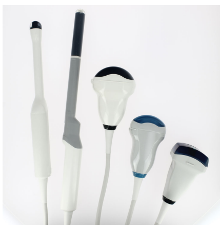
FIGURE 3.4 – Exemples de sondes [30]. Elles peuvent être mono-élément, en barrette ou matricielle, mobile ou fixe, concave ou plate.
