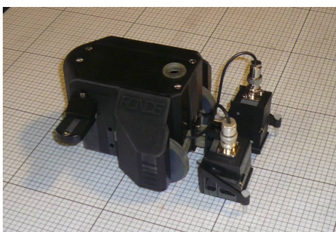
(a) Le robot possède trois roues pour se déplacer et deux transducteurs aériens (à droite du robot).
