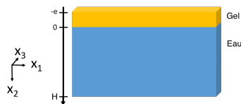
(b) Représentation du gel sur l'eau. Avec e = 18\text{mm} et H = 400\text{mm}
