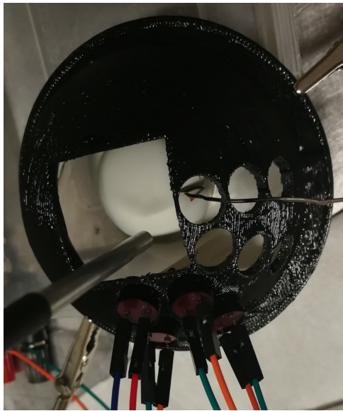
(a) Photo du montage avec le ballon de baudruche (blanc). Le ballon est rempli d'eau et est fixé avec support transparent. Les quatre émetteurs sont en positions 1A , 2A , 1B et 2B . Le récepteur est au niveau de la surface de la coupelle et balaye la surface.
