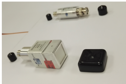
FIGURE 4.6 – Transducteur Ultran (et au deuxième plan l'adaptateur d'impédance électrique livré avec). Le transducteur a une face avant carrée de 13\text{mm} de côté.
