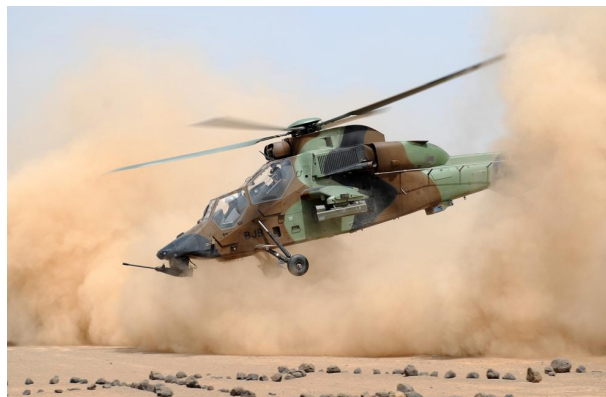
FIGURE 1 – Photo d’un hélicoptère Tigre entouré d’un brownout (Source : Expérimentation du TIGRE HAD sur le territoire djiboutien).
