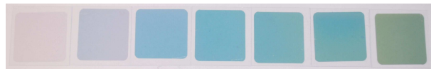
Figure 3.2 – Photographie des films d'or pour des fractions surfaciques d'or allant de 30% (gauche) à 99% (droite).
